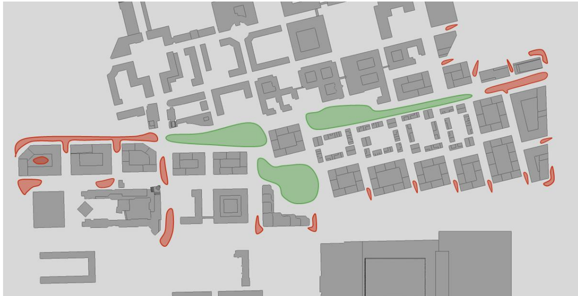
Markering af områder, hvor bygningerne hhv. accelererer vinden (rød) og hvor bygningerne skaber læ (grøn).
